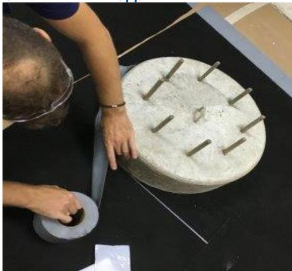
MasterSeal® 935 – это двухсторонняя клеящая лента на основе бутил-каучука. Бутилкаучуковая лента оснащена защитной пленкой со швами для легкого снятия.
