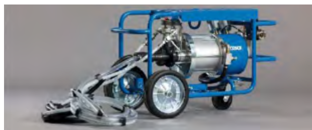
Przykładowa dwuskładnikowa pompa wtryskowa
