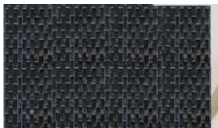
4. Klipp det tørre fiberstoffet i korrekt bredde og lengde med saks eller kniv.
