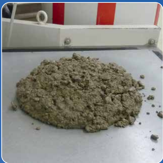
Betong med fint tilslag forurenset med svelleleire, uten MasterSuna
