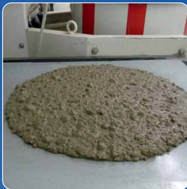
Betong med fint tilslag forurenset med svelleleire, med MasterSuna
