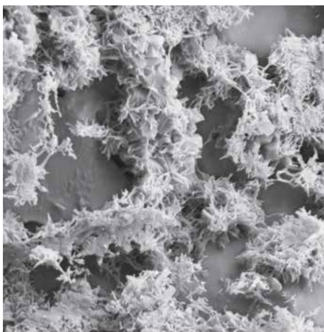
CryoSEM av Master X-Seed: Aktive krystaller vokser i mellom sementkornene
