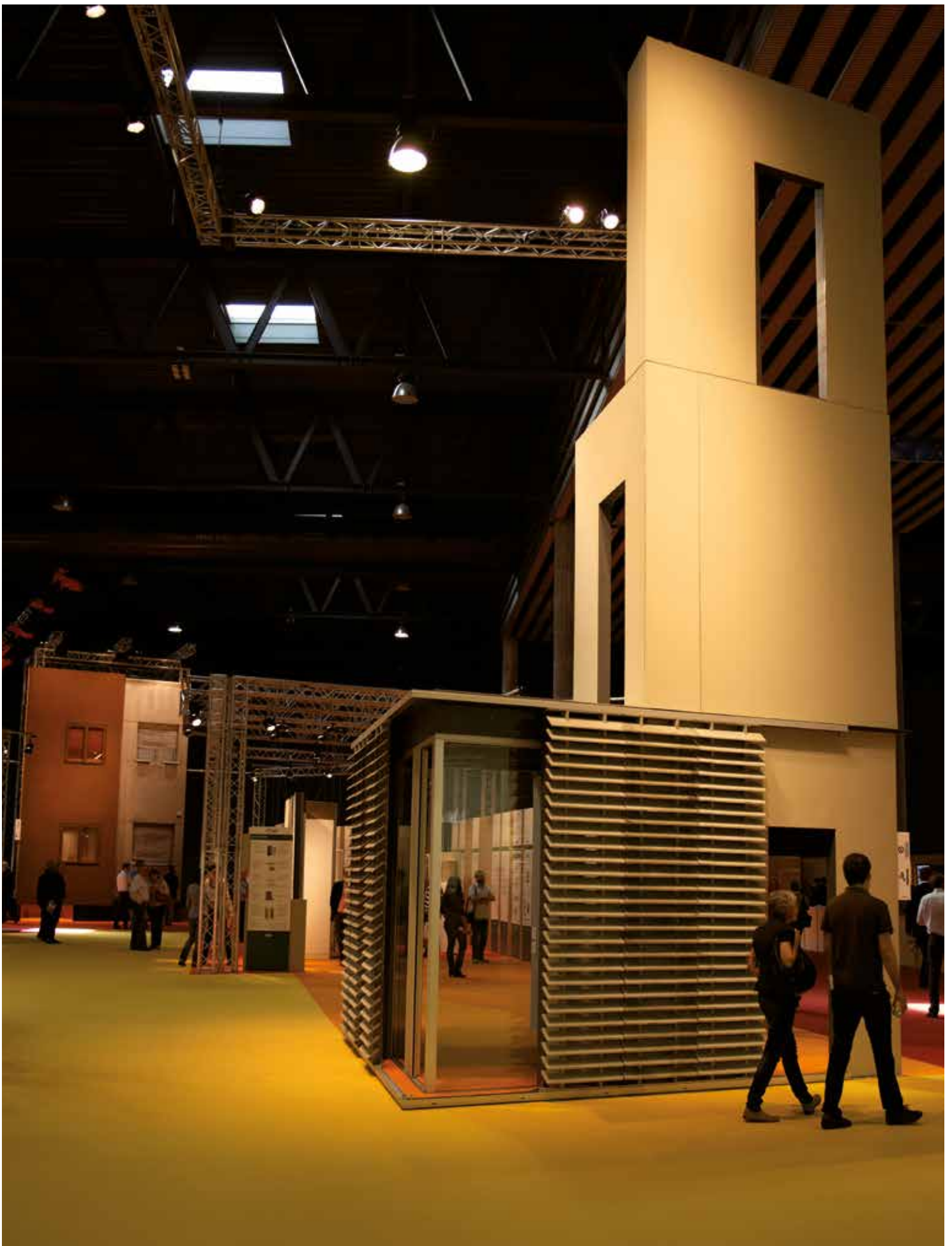
Hybridirakenne, joka on tehty teräksestä sekä MasterFiberillä kuituvahvistetusta, erittäin korkealujuusisesta betonista valmistetuista ohuista paneeleista ja sälekaihtimista. R&D-projekti, jonka on kehittänyt ASCAMM \ iMat – Construction Technologies.
