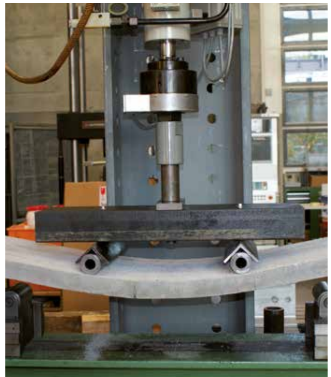
4-pisteen taivutusvetolujuustestausta LMC:n laboratoriossa
