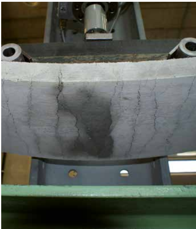
MasterFiber-kuidulla vahvistetun rakenteen monihalkeilukäyttäytymistä
