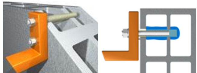
Fijación en bloques huecos
