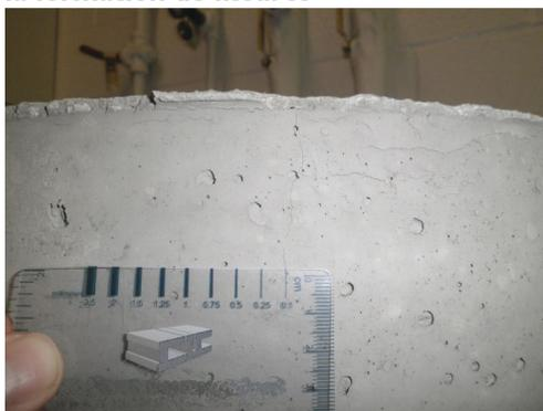
Largeur de la fissure  $\approx 100 \mu\text{m}$  (0,1 mm)
