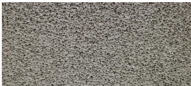
Abb.: Schaumstruktur mit einer Dichte von 75 kg/m 3
