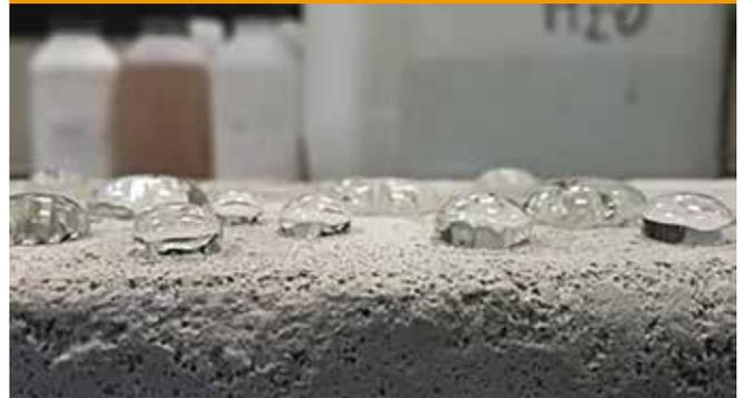
Zur Hydrophobierung der Blöcke. Die kapillare Wasseraufnahme wird reduziert, während die Diffusionsfähigkeit erhalten bleibt. Feuchtigkeitsbildung im Mauerwerk wird vermieden.
