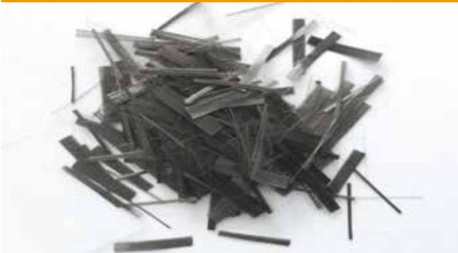
Reduziert die Rissbildung und minimiert das Schwinden. Die Fasern können ein Netzwerk innerhalb der Blöcke bilden. Dies erhöht die Stabilität. Somit werden Brüche während des Handlings verringert und letztendlich der Ausschuss reduziert.
