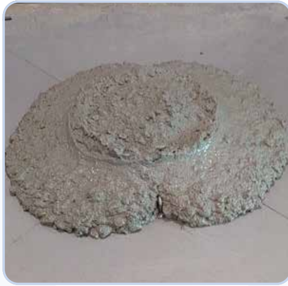
Blanding I Referencebetonblanding (konventionelt superplastificeringsmiddel): CEM II/A-LL 32.5, 363 kg/m 3
