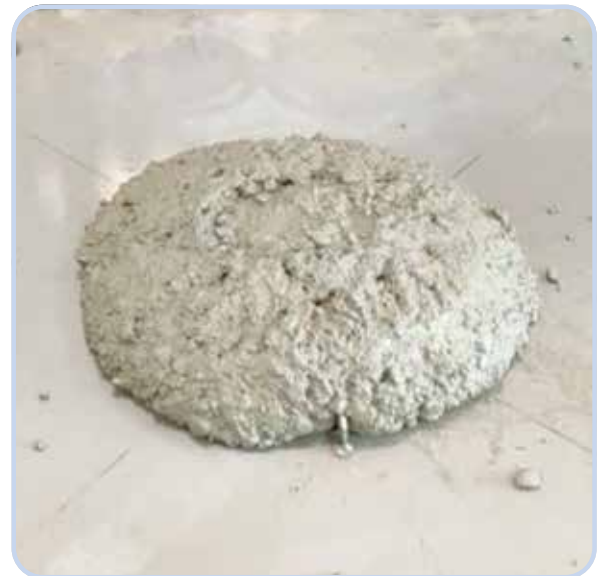
Blanding 3 Betonblanding med MasterCO 2 re™: CEM II/B-LL 32.5, 307 kg/m 3
