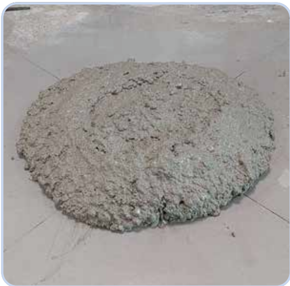
Blanding 2 Betonblanding med MasterCO 2 re™: CEM II/B-LL 32.5, 330 kg/m 3
